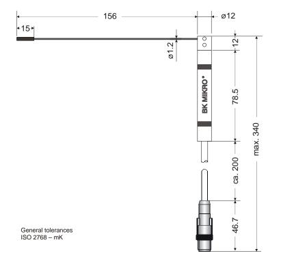
Abb. 4-8: Mechanische Abmessungen – Tastkopf TK94A
