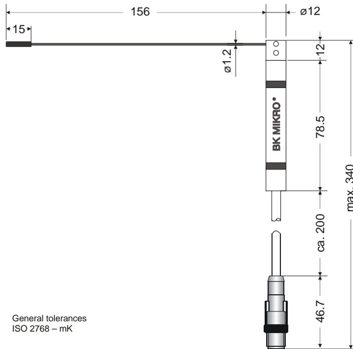
Abb. 4-8: Mechanische Abmessungen – Tastkopf TK94A
